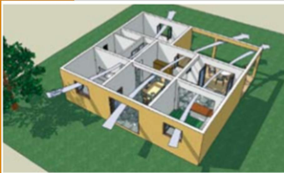
Le critère déterminant est le taux d'ouverture. C'est le rapport entre la surface d'ouverture et la surface de la façade considérée. C'est ce qu'on appelle la porosité.
